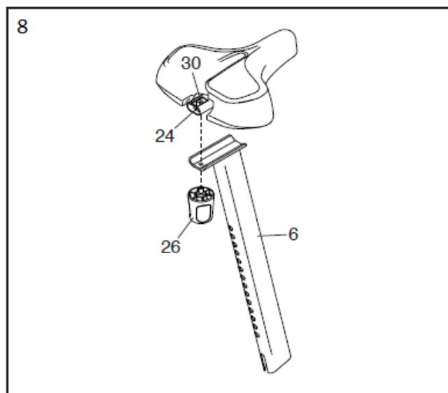
9. Vložte sedlo spojené se sedlovým rámem do otvoru pro připevnění sedlové soustavy (28) a zajistěte aretačním kolíkem (27). Ujistěte se, že je aretačním kolíkem (27) zajištěno v jednom z otvorů sedlového rámu (6).
