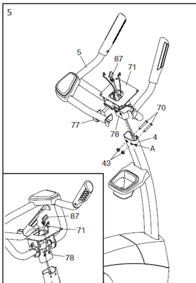
6. Před připojením počítače trenažeru, nejprve propojíme kabeláž stroje. Propojte kabely model (61) a hlavní kabel (87). Přebytečnou délku kabelů vložte směrem dolů do otvoru otočného držáku model/řídiček (71).
