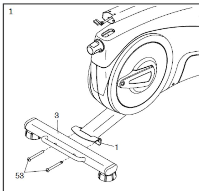
2. Připevněte přední stabilizátor (2) k hlavnímu přednímu rámu (1), pomocí šroubů M10 x 98 mm (53).
