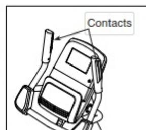
Držte madla pevně. Jakmile je srdeční tep detekován, zobrazí se tep na displeji. Pro přesnější měření držte senzory min. po dobu 15 vteřin.
